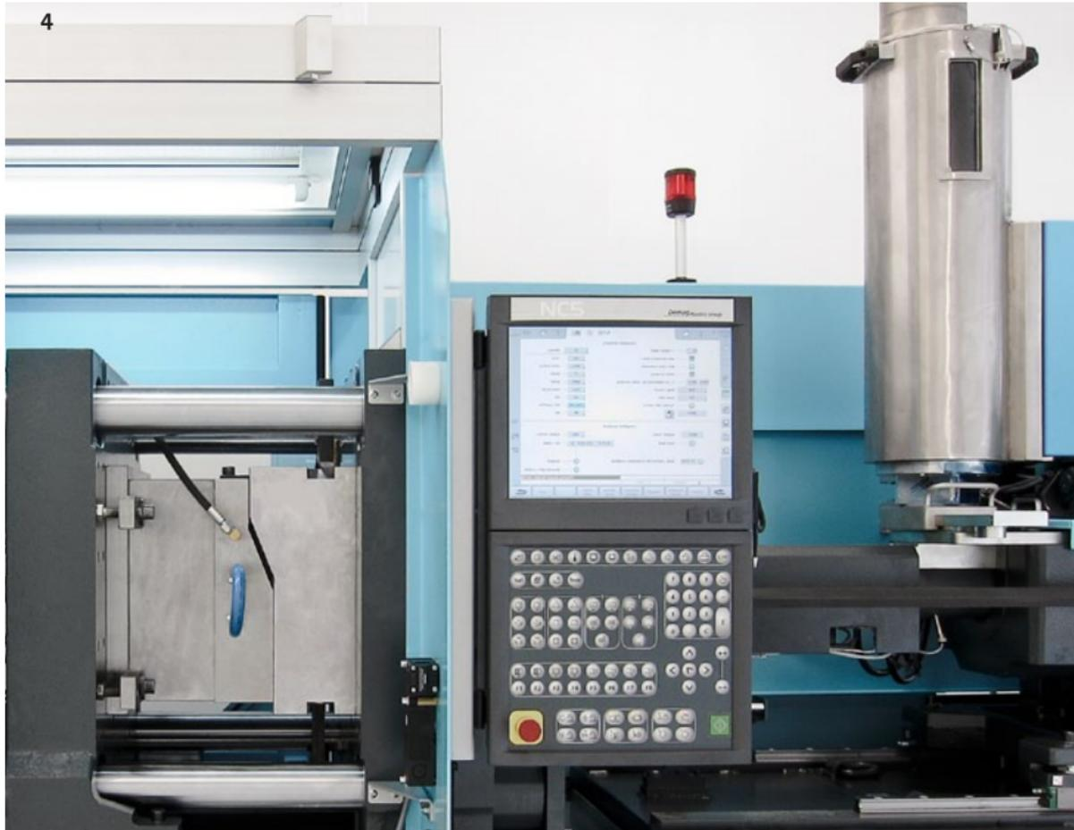
**Vollelektrische Spritzgiessmaschine, schmierfettfreies Formwerkzeug und laminarströmende Reinluft für die Fertigung von Spritzgussteilen unter Reinraumbedingungen**
