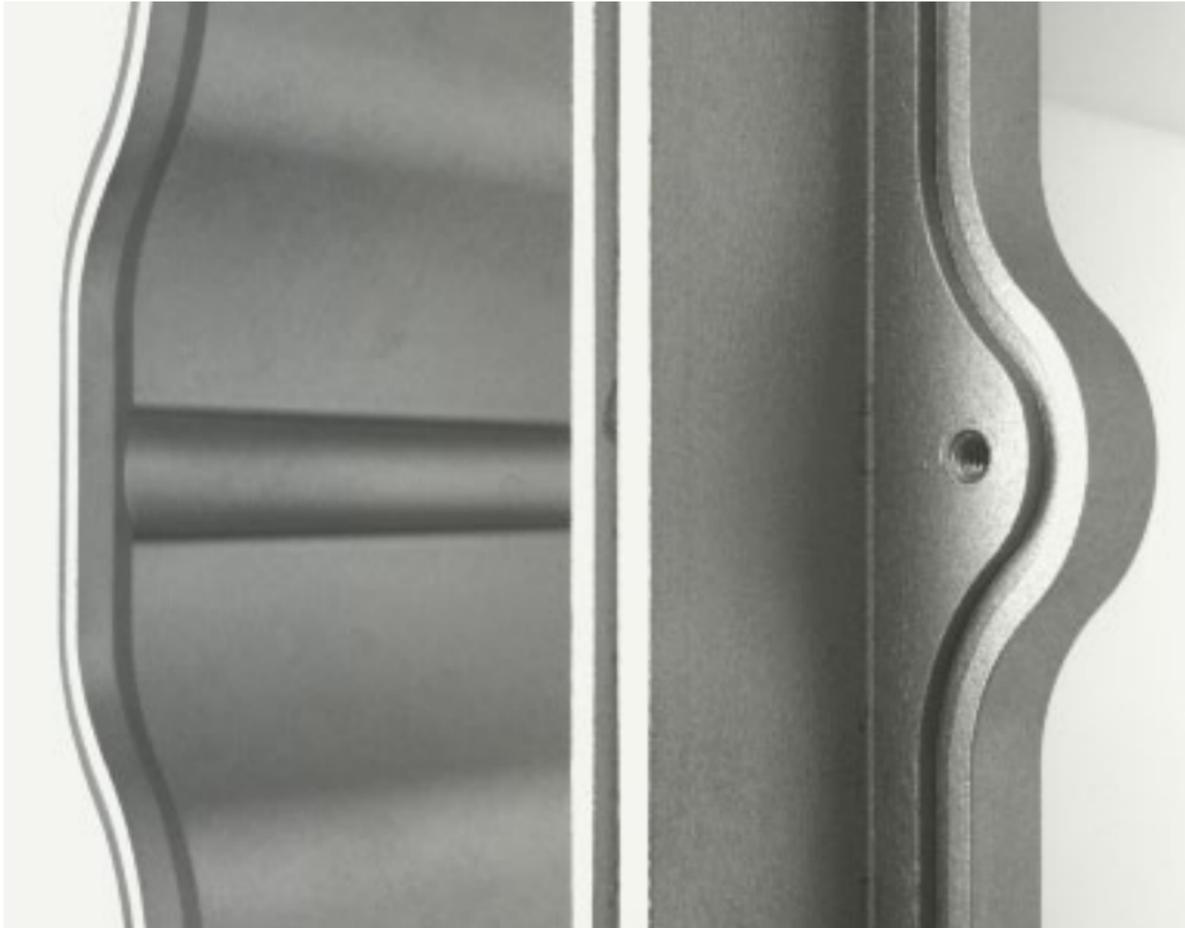
Innenseite eines Gehäusebauteils für ein elektronisches Gerät. Hergestellt im Thermoplastischen Schaumguss (TSG) aus Styrol/Butadien. Das Gehäuse ist innen mit einer Graphitbeschichtung elektrisch abgeschirmt und außen mit einem hochwertigen Strukturlack versehen.
